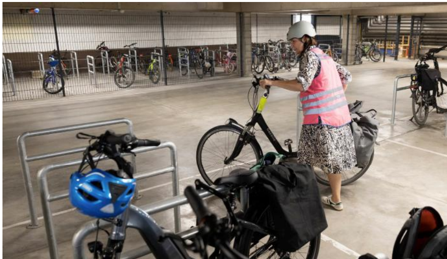
Figuur 32: Fietsbeugel met tussenbeugel (Bron: vademecum fietsvoorzieningen)
