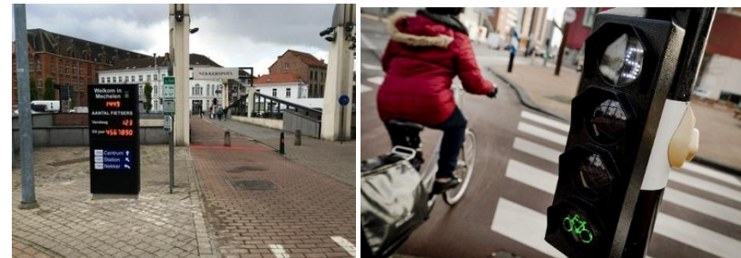
Figuur 50: Fietstelpaal Mechelen Nekkerspoel (links) en wachttijdvoorspeller voor fietsers (rechts)
